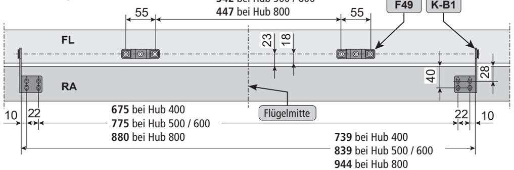
**Bohrbild für Konsolen K-B1 und Flügelbock F38 am Wing 105D (RAICO)**
