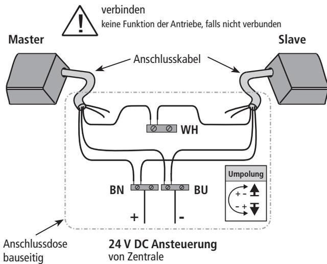
WH dient zur Kommunikation, bei synchronisiertem Mehrfachbetrieb
